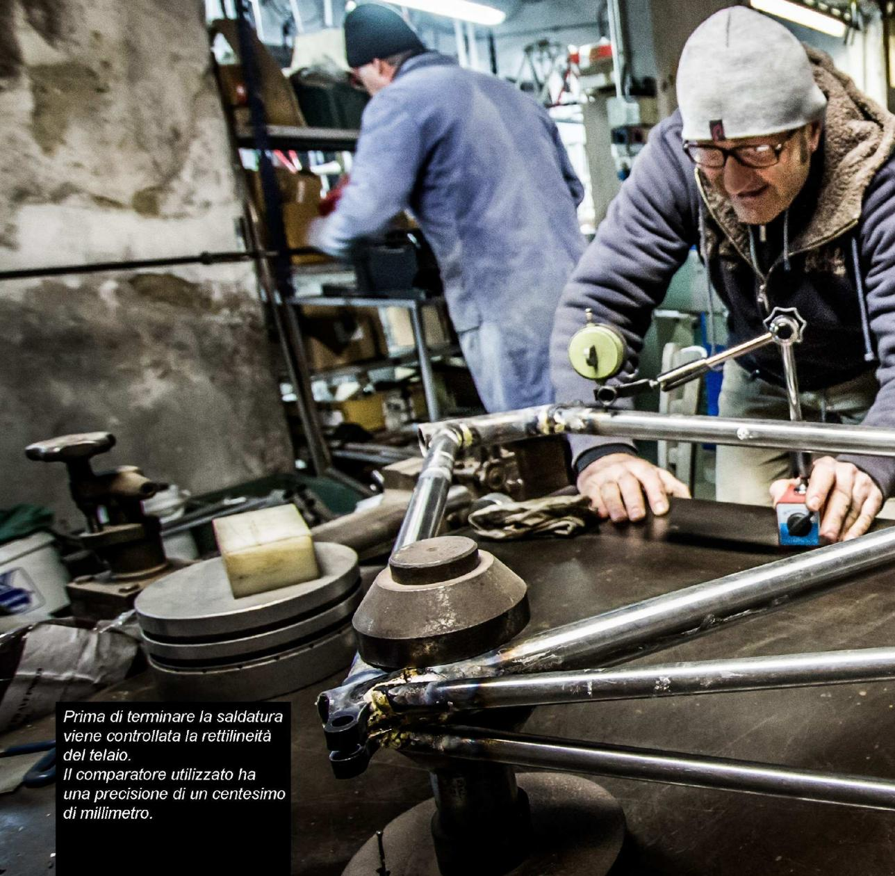
*Prima di terminare la saldatura
