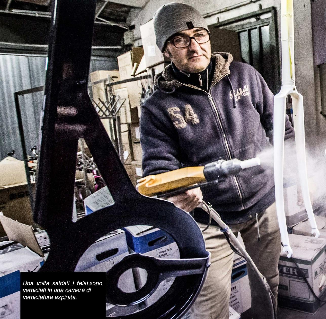
*Una volta saldati i telai sono verniciati in una camera di verniciatura aspirata.*
